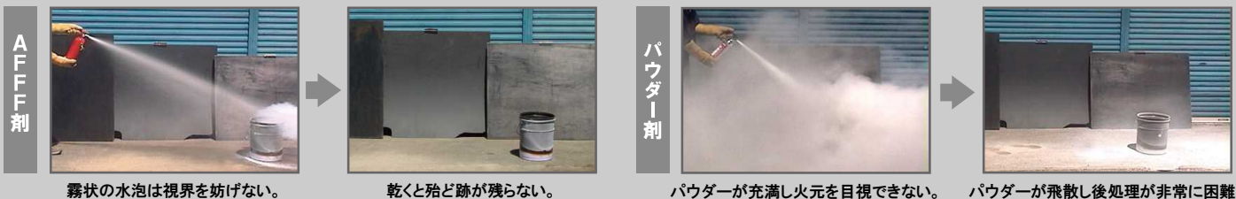
霧状の水泡は視界を妨げない。 乾くと殆ど跡が残らない。 パウダーが充填し火元を目視できない。 パウダーが飛散した後処理が非常に困難。
